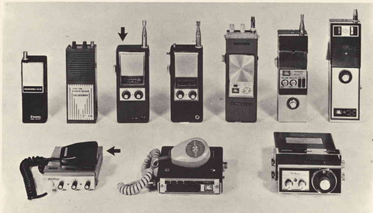
Fig. 1 - Panoramica di una serie di radiotelefoni portatili o Walkie-Talkie (in alto nella foto) e di tre modelli per impianto fisso per il Canale 1 dei 27 MHz.
