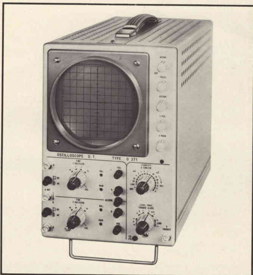
Fig. 1 - Oscilloscopio TES modello 0371 a doppia traccia. Banda passante cc a 8 MHz. Sensibilità Y, 10 mV/pp/cm. Sensibilità monotraccia 1 mV/pp/cm. Asse dei tempi da 0,1 \mu s a 20 ms/cm. Funzionamento con trigger o ricorrente. Tubo da 5" piatto.
