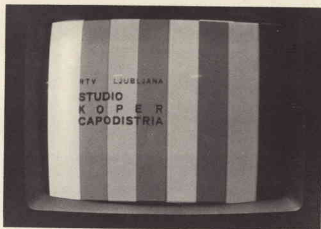
Fig. 5 - Immagine prova per emissione a colori dello studio televisivo di Capodistria. Colori delle fasce partendo da sinistra: bianco, giallo, celeste, verde, rosa, rosso, azzurro, nero.
