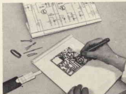
Fig. 2 - Preparazione di un circuito stampato mediante la trousse LC-350.
