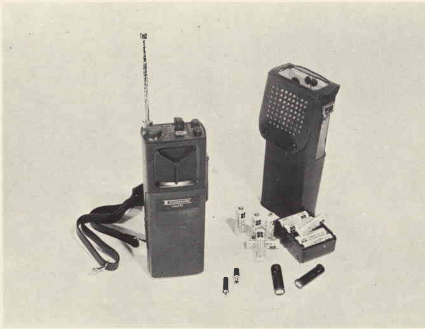
Fig. 7 - Ricetrasmittitore portatile per le VHF marine della Standard. Prevede 1 W di potenza di uscita e 5 canali di servizio. Speriamo che questo radiotelefono possa venire omologato dal Ministero PT in modo da costituire un mezzo valido e non troppo costoso.
