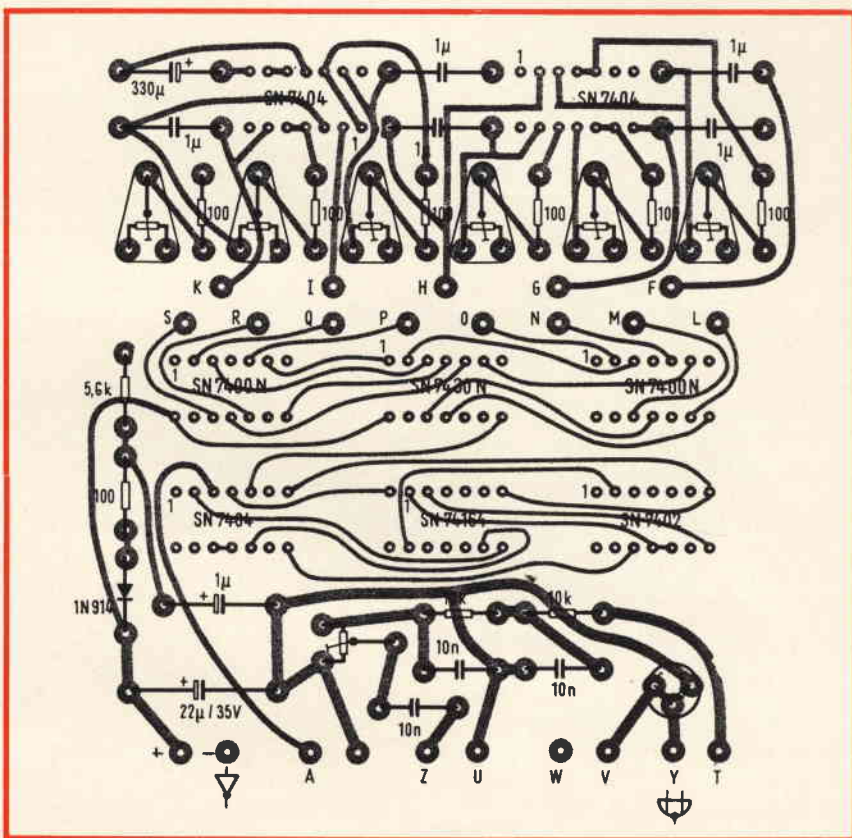
Fig. 5 - Circuito stampato in grandezza naturale visto dal sotto.
